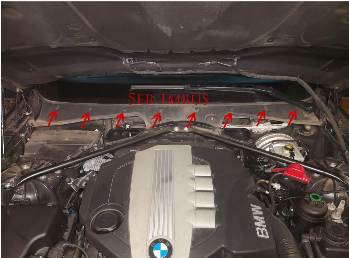
Links und rechts am Rand der Abdeckung muss man noch eine Mutter lösen, die lässt sich aber gut von Hand drehen. Danach die Abdeckung entfernen. Jetzt kann man das Wischergestänge schon gut sehen und man kann erkennen, dass dieser Alu Block (Lagerbock Querstrebe) in der Mitte auch noch entfernt werden muss damit man das Gestänge ausbauen kann. Der Lagerblock ist mit 4 Schrauben befestigt, 2 davon sind zu sehen und die anderen 2 liegen verdeckt.
