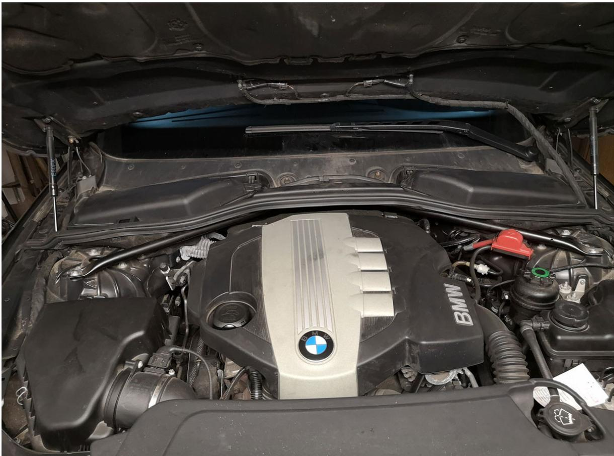
Als erstes werden die Innenraumfilter die links und rechts im Motorraum unterhalb der Scheibe sitzen ausgebaut. Dazu die Klammer an der schrägen Seite nach vorne klappen und die Schraube mit einer 13er Nuss mit einer Vierteldrehung lösen. Auf der linken Seite muss auch noch der Stecker abgezogen werden.
