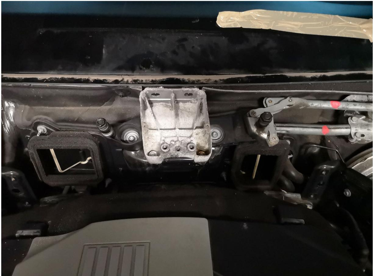
Wer die Wischerarme noch nicht entfernt hat, sollte es jetzt tun. Dazu die Kappen bei den Wischerarmen mit einem kleinen Schraubenzieher abheben. Auf der Fahrerseite die Mutter mit einer 16er Nuss lösen. Auf der Beifahrerseite sind es zwei Muttern, eine 16er Nuss und eine 13er Nuss. Danach mit einem Abzieher die Wischerarme entfernen. Jetzt kann das Wischergestänge mit seinen 5 Schrauben (T30), ausgebaut werden.
