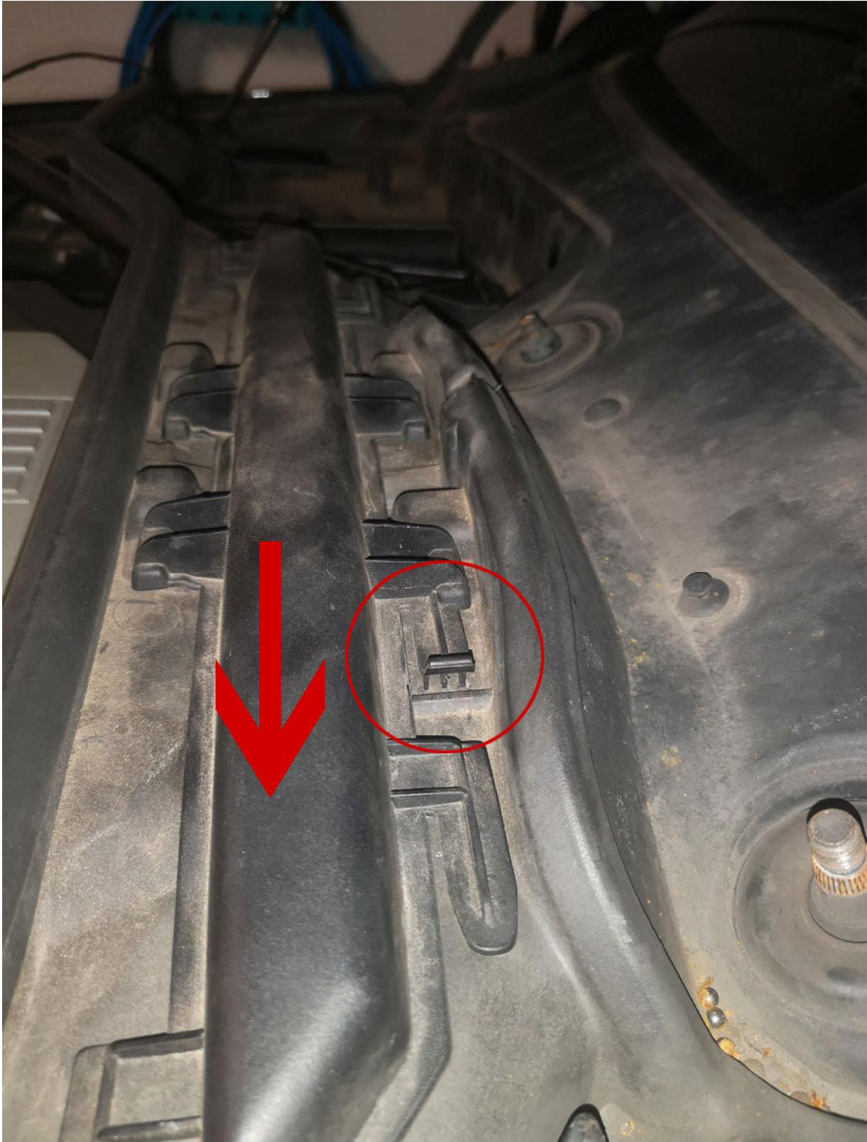
Darunter kommt wieder eine 13er Schraube zum Vorschein. Diese auch mit einer Vierteldrehung lösen genau wie die anderen auch. Dazu muss noch jeweils links und rechts am Federbeindom eine 8er Schraube gelöst werden.
