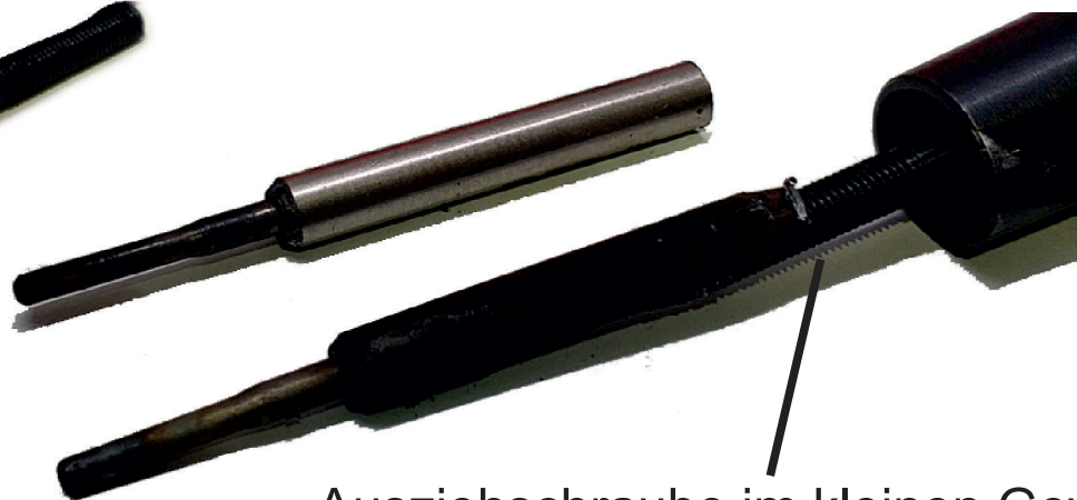
Ausziehschraube im kleinen Gewinde des Glühkerzenstumpfes
