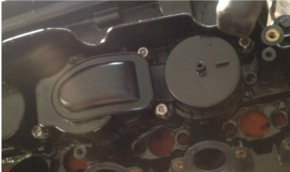
Abb. 26 Ölabscheider (Injektoren entfernt)
