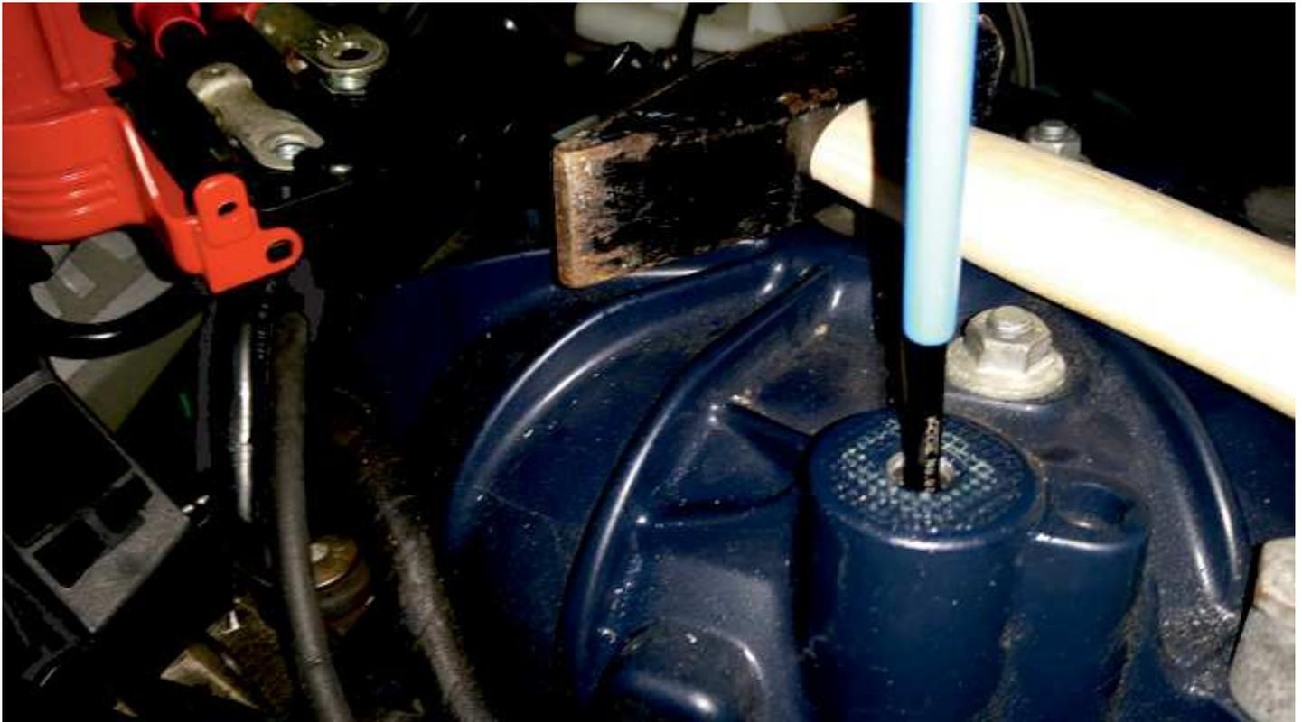
Zum Schluß schlägt man die Eindrehhilfe mit dem beiliegenden Abschläger und einem Hammer ab.
