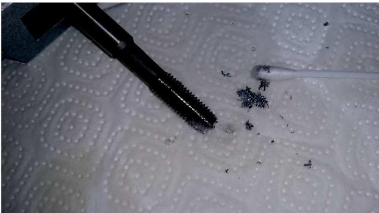
Zwischendurch kann man den Gewindeschneider auch mal reinigen.
