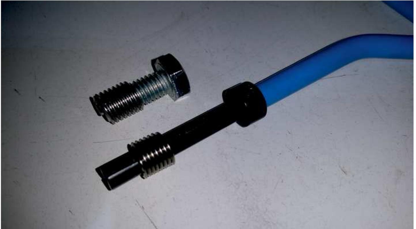
Nachdem das Gewinde gereinigt wurde, kann man den Helicoil eindrehen. Dazu nimmt man die Eindrehhilfe, wie oben auf dem Bild.
